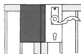
**T**e lassen (geschuurde) tegenkasten voor poorten met twee vleugels uitgerust voor de installatie van een elektrische deuropener. Deze tegenkast is links en rechts omkeerbaar.
