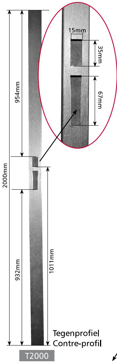
ProfieLEN met slot, cilinder en klinken. 40 x 40 x 2mm
