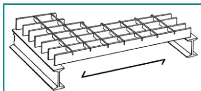
Dit zijn de staven, die de last opnemen en daarom aan weerszijden zijn ondersteund. Deze afmeting wordt steeds eerst aangeduid.
