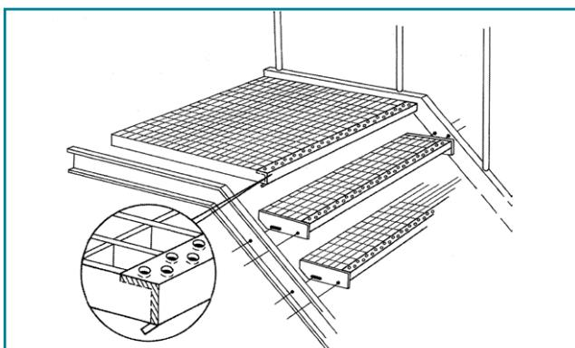
Door een veiligheidsneus aan de voorzijde van de treden te voorzien, ontstaat een duidelijke visuele onderscheiding tussen de treden onderling. De aangelaste en voorgeboorde zijplaten dienen voor een snelle en eenvoudige montage aan de trapbomen.
