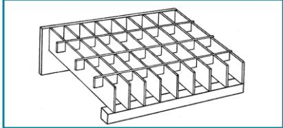
Om de roosters op het niveau van de vloer te leggen, kan een naar onder overschrijdende plint, of een aangelast buisprofiel worden gebruikt.
