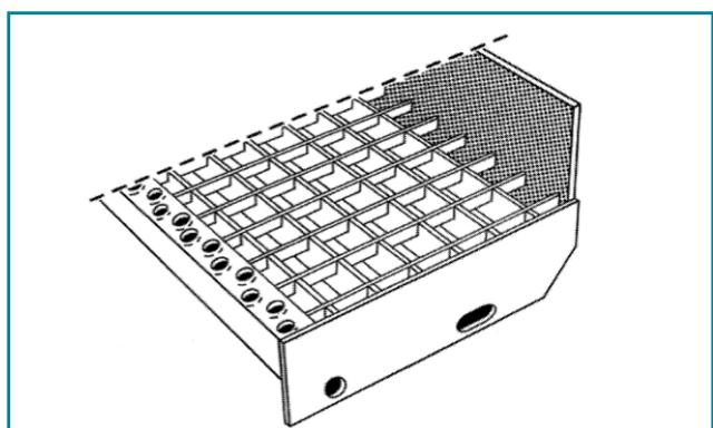
Aan de achterzijde van de trede wordt over de volledige lengte een opstaande platijzer gelast. Dit verhindert het afvallen of het afschuiven tussen twee trapsteden.
