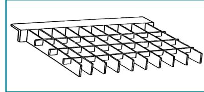
Aan de uiteinden van de draag-staven kan een hoekprofiel worden gelast om de roosters in de opening te hangen. Enkel voor personenbelasting.
