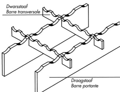
Voor de antislipvoering in de richting van de dwarsstaven is het mogelijk dat deze staven op aanvraag iets hoger worden geplaatst, zodat de voet slechts op de dwarsstaven contact heeft.
